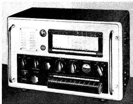
Bild 1. Hagenuk-Schiffsfunkempfänger UE 11
